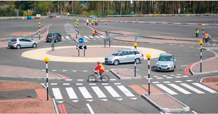
Holland típusú körforgalmak, amelyek a láthatóság maximalizálása érdekében úgy lettek kialakítva, hogy a körfor-galmat elhagyó gépjárművek közel 90 fokos szögben közelítsék meg a kilépősávot [1].
